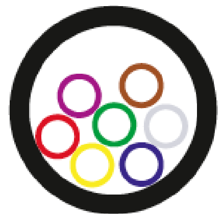
Exempel på 7x7/5,5 mm mikrorör i 40/32 mm optorör.
